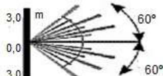
Instalado em parede (entre 1,0m a 1,5m de altura) do piso, alcance de até 6 m com 120° - 25° c dependendo do ambiente.
